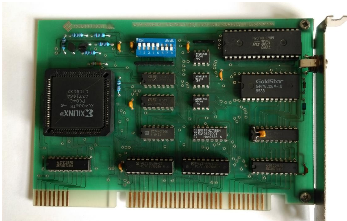
Obr. 3: Prídavná karta DATA OFFICER s podporou šifrovania na báze hardvérovej implementácie šifrovacieho algoritmu SEA64 do programovateľného poľa XILINX
