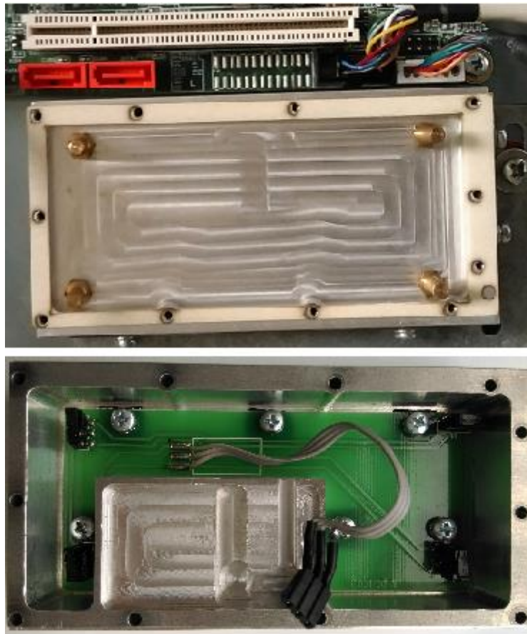
Obr. 9: Detaily ochranného bloku karty CODESTAR 2 DSP. V hornej časti obrázku je spodná časť priskrutkovaná k spodnému víku šifrátoru hneď vedľa základnej dosky tak, aby do jej PCI slotu zasunutá rohová riser karta poskytla konektor PCI slotu pre kartu CODESTAR 2 DSP.
