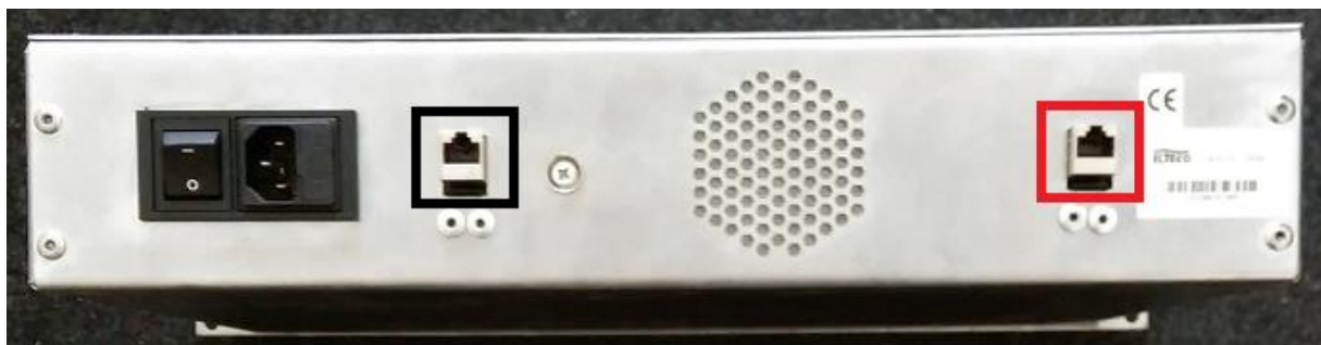
Obr. 10: Zadný panel šifrátoru so sieťovými konektormi RJ45 pre červenú (otvorené nešifrované dáta) a čiernu (šifrované dáta) stranu siete podľa BŠ.
