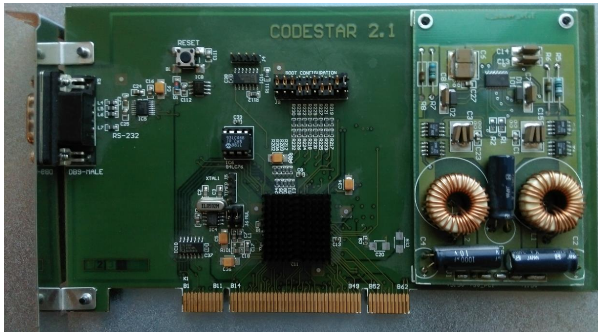
Obr. 18: PCI karta CODESTAR 2.1 DSP
