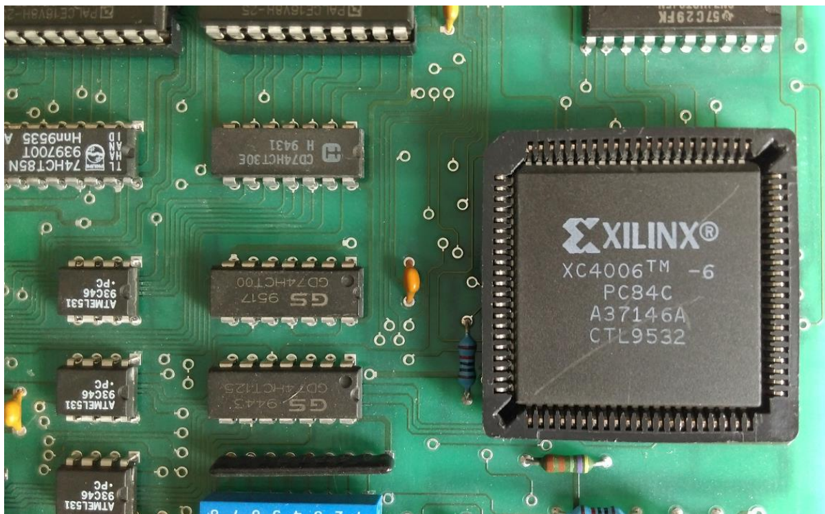
Obr. 4: Detail z prídavnej ISA karty s poľom XILINX
